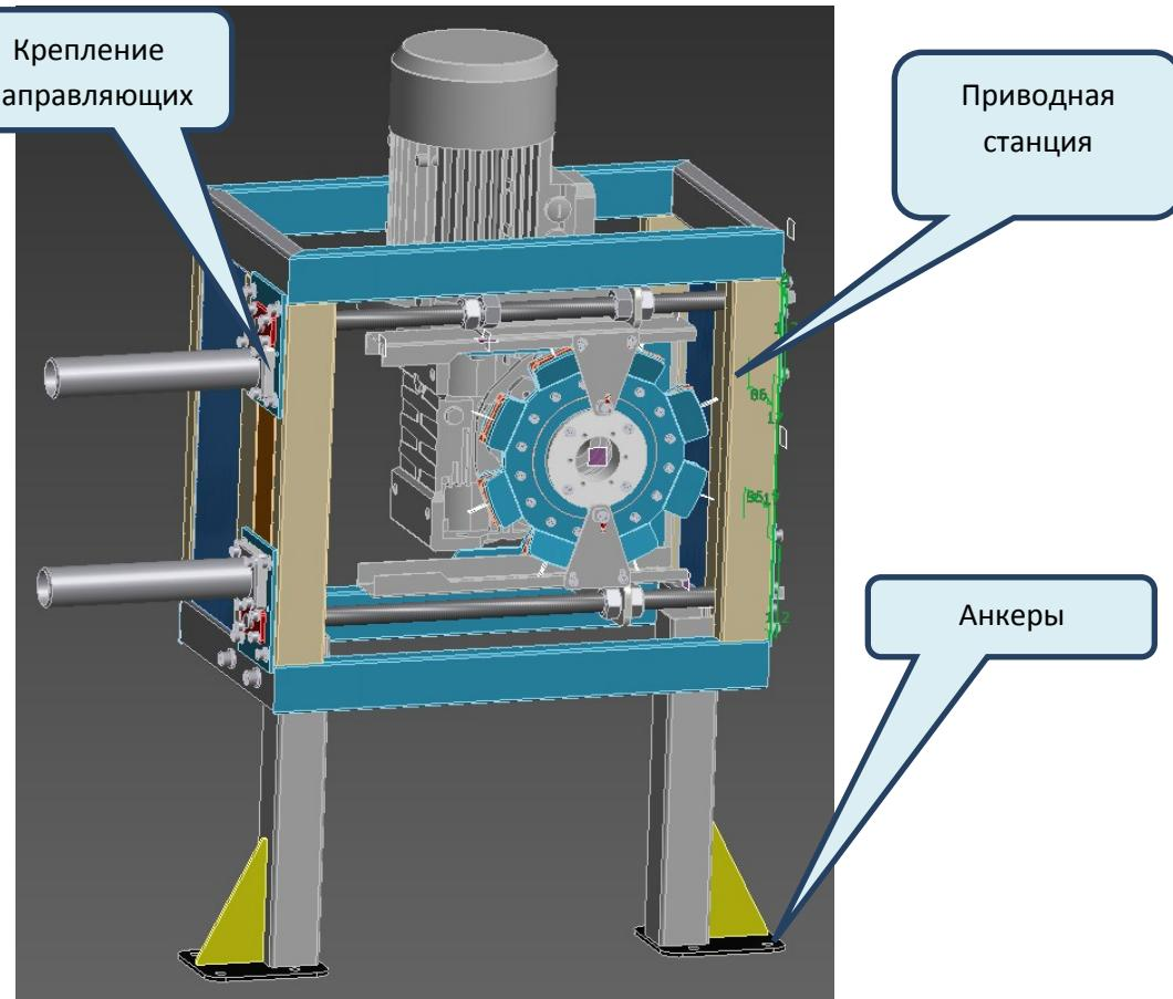
12. Снять с троса держатели и заправить трос с шарами в направляющие и приводное колесо. Шары троса должны быть уложены в гнезда колеса, а трос вставляется между токосъемными пластинами, с некоторым натягом, упруго разжимая последние.
