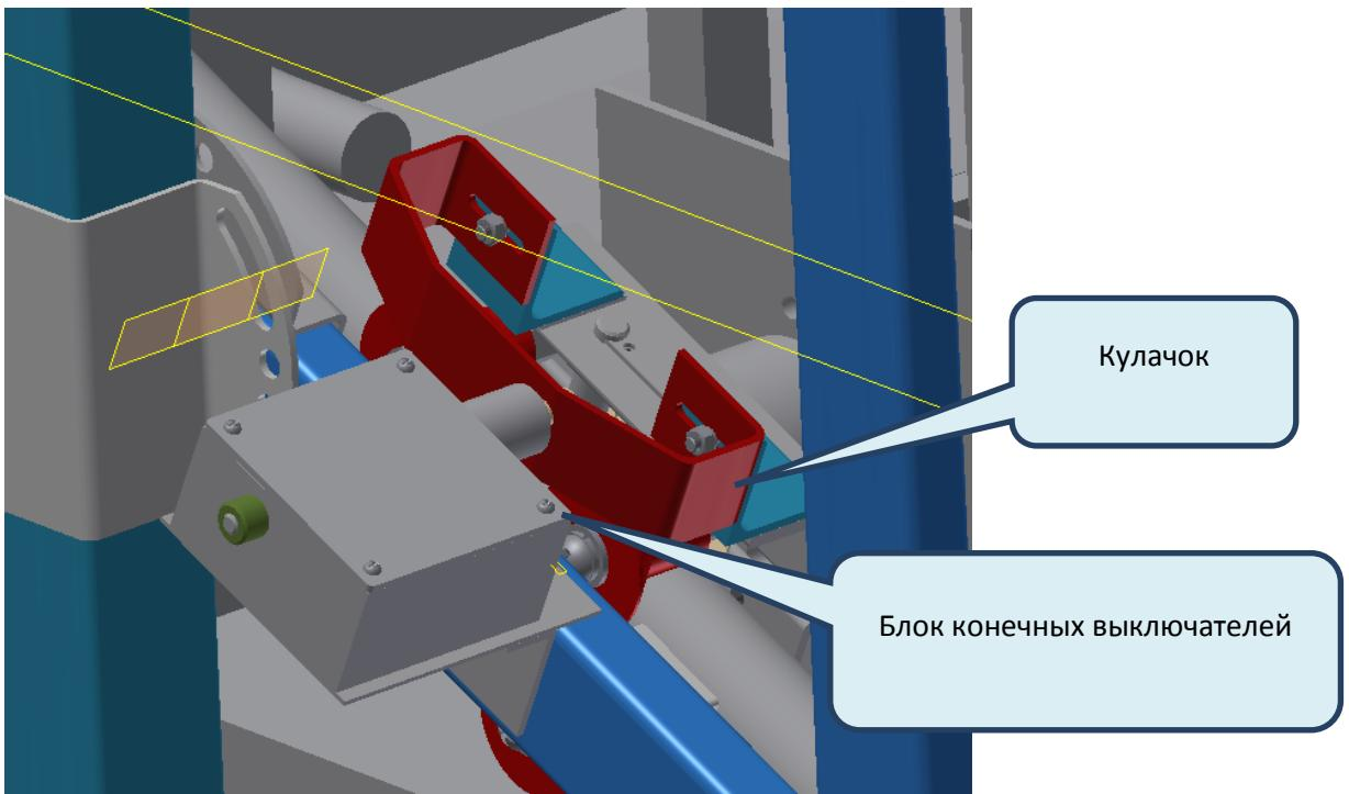
24. После проведения электромонтажных работ произвести первый запуск (без нагрузки), убедившись в отсутствии посторонних предметов на пути ПНС.
