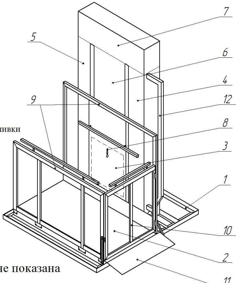
2.5. Снять центральную лицевую (6) и обшивку с верхней части корпуса (7) – защиты привода.
