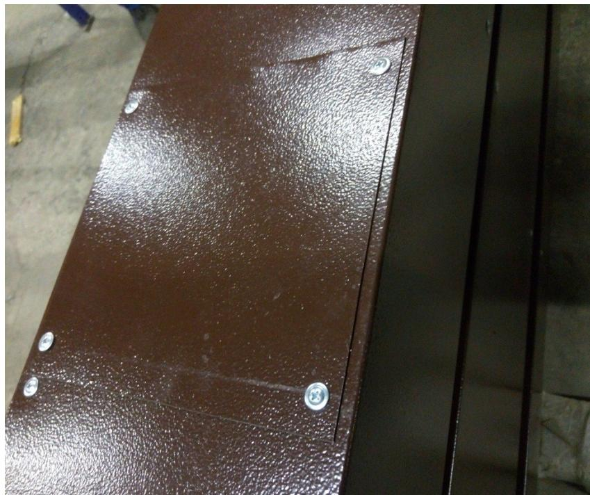
3. Выкрутить вверх винт M6, предохраняющий упор от случайного поворота;
