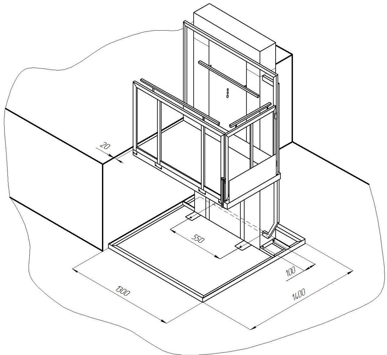
2.7. При необходимости крепления подъемника к стене, в комплект поставки включаются регулируемые кронштейны. Длина регулировки: 175...265 мм. При наличии таких кронштейнов необходимо:
