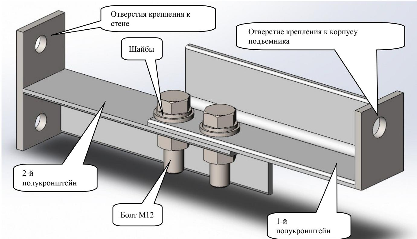
2.8. Закрепить платформу на каретке корпуса (3) винтами M12.
